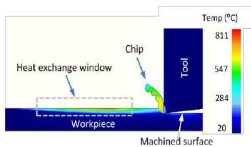
Ti-6Al-4V.  $v=100 \text{ m/min}$ ,  $a_p=0.2 \text{ mm}$
